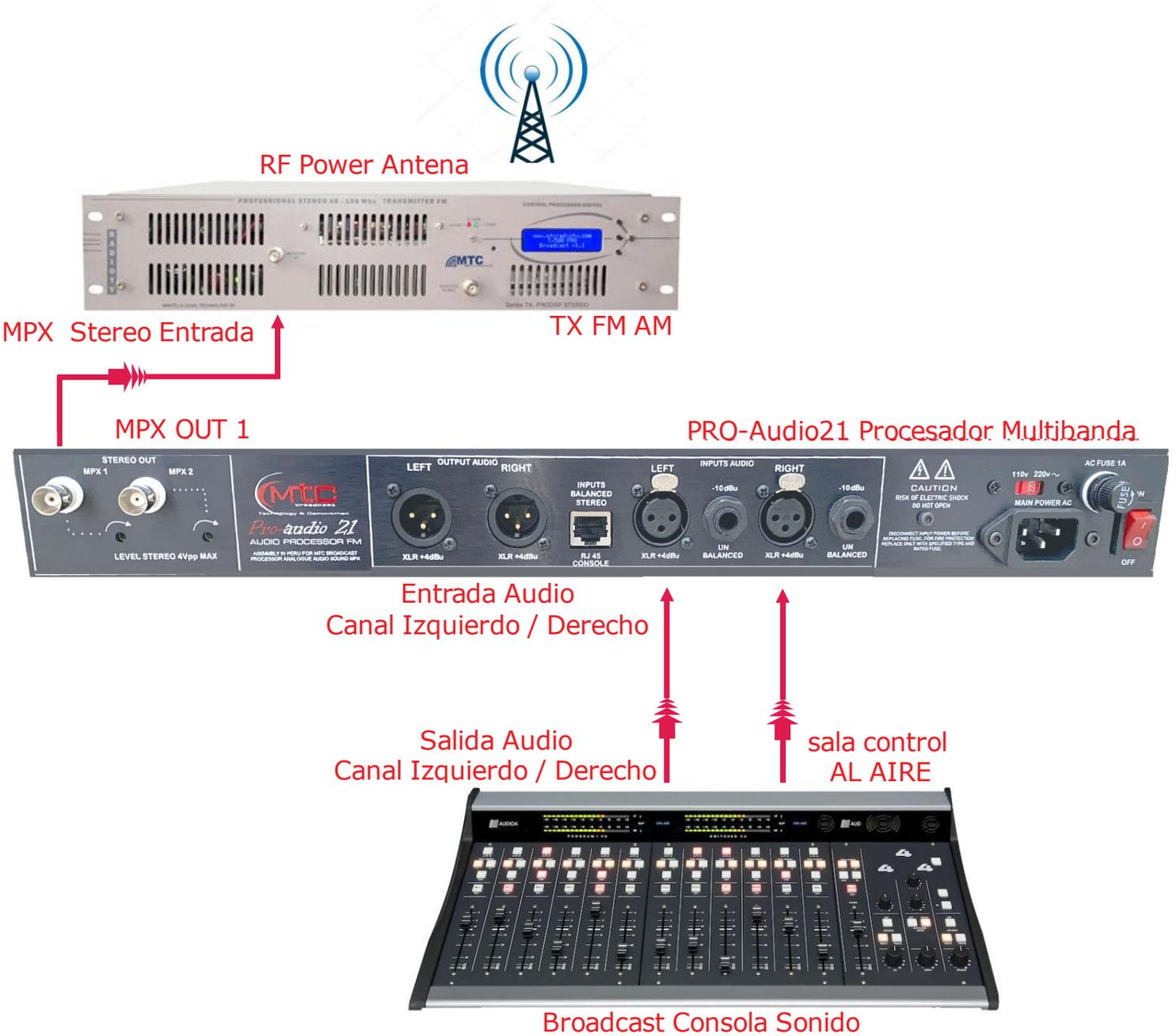
**RECOMENDACIÓN IMPORTANTE:** Es obligatorio que el cable utilizado para la conexión entre la salida MPX del **Pro-Audio21** y la entrada MPX del TX transmisor sea lo más corto posible. Esto evitará cualquier distorsión u Ruido.
