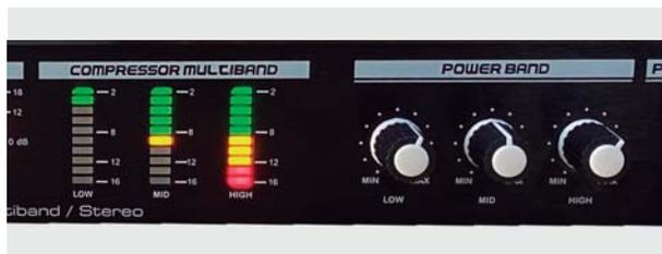
El PRO AUDIO 21 trabaja con 3 compresores activos independientes en cada banda del espectro, permitiendo con esto ajustar las frecuencias cruce de los filtros para dividir la señal en distintas bandas, el tiempo de liberación con el tiempo de ataque es crucial dentro del sistema, para realzar la contundencia del sonido al aire ajustando los controles de manera personal, creando un carácter de compresión brutal.
