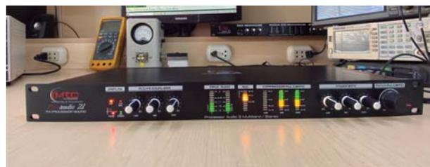
Una vez ajustado al máximo la entrada de audio MPX del TX transmisor y sin conexión del pre-énfasis, proceda agregar el sonido. Coloque todos los controles dando las 12 del reloj..... es todo! el PRO-AUDIO21 maravillosamente hará sentir el impacto y fuerza sonora con fácil manipulación de sus 7 controles y un panel frontal intuitivo, permite configurar a gusto la energía de su radio.
